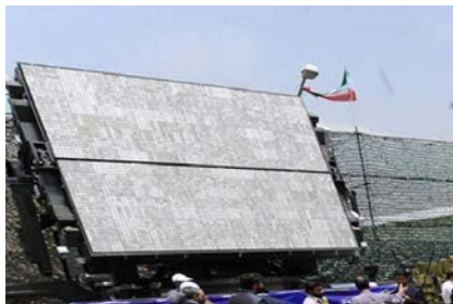
МРЛС «Назим 802» с полотном антенной решётки
