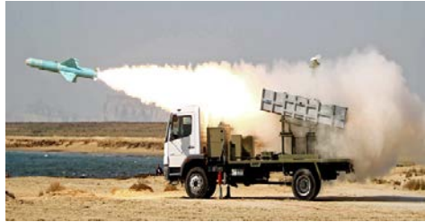
Пуск ракеты «Наср»-1 с СПУ берегового ракетного комплекса
