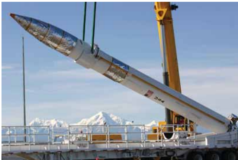
Противоракета шахтного базирования GBI устанавливается на пусковой позиции позиционного района ПРО на Аляске
