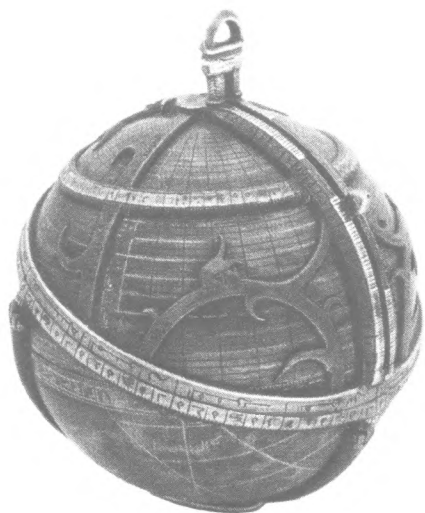
Сферическая астролябия. (Исламские страны, 1480 г. по Р.Х. Музей истории и науки, Оксфорд).
