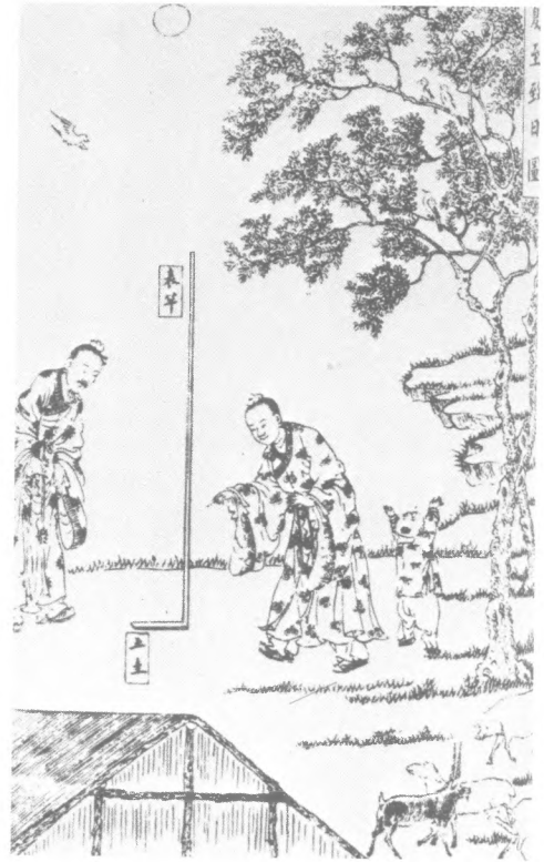
Изображение измерений тени в период солнцестояния, проводимых Хси Шу в легендарные времена поздней династии Чин, измерения проводились с помощью гномона и шаблона тени гномона. (Нидхем, том III, рисунок 110).
