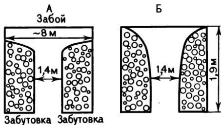
**Рис. 38. Схематическая зарисовка выработанной штольни:**
