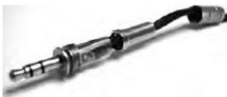
Рис. 2.21. Мини-разъем 3,5 мм
