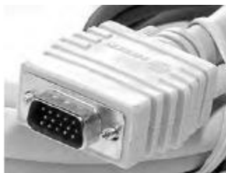
Рис. 3.1. Разъем D-sub
