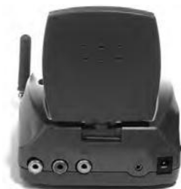
Рис. 2.18. Задняя панель аудиосендера – аудио- и
