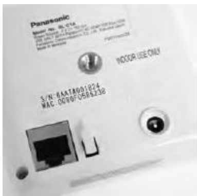
Рис. 6.2. Сетевая камера имеет разъемы для питания и сети
