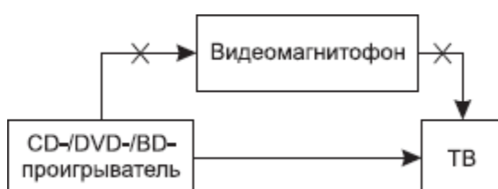
Рис. 4.9. Если при подключении проигрывателя с чейнджером в изображении телевизора появляется шум, следует исключить из цепи
