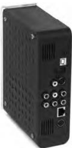
Рис. 4.12. Выходные разъемы мультимедиаплеера
