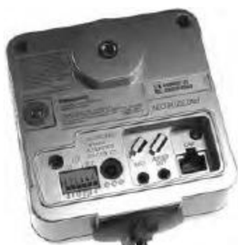
Рис. 6.3. Порты подключения сетевой камеры
