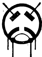
Двойной диод или двуханодный нектрон с разделенными катодами
