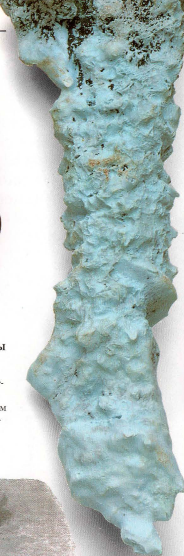
Отложения медного минерала халькантита на кровле горной выработки
