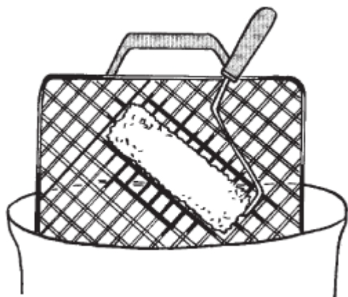
Рис. 51. Удаление лишней краски с помощью отбрасывающей решетки
