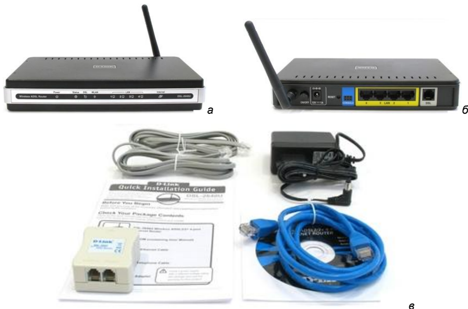
Рис. 6.12. Точка доступа DSL-2640U: а — вид спереди; б — вид сзади; в — комплект поставки
