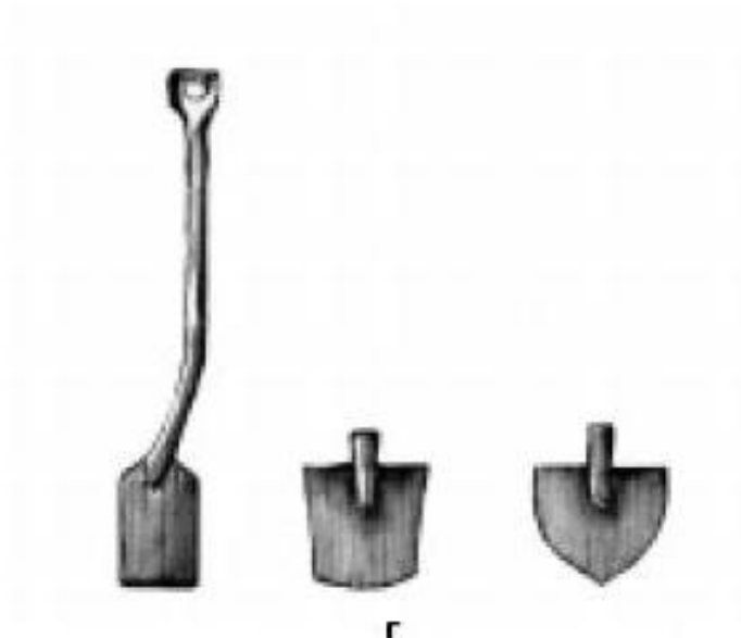
Инструменты для уборки урожая: а — нож садовый; б — ножницы садовые (секатор); в — вилы садовые; г — лопаты для легкого, среднего и тяжелого грунта
