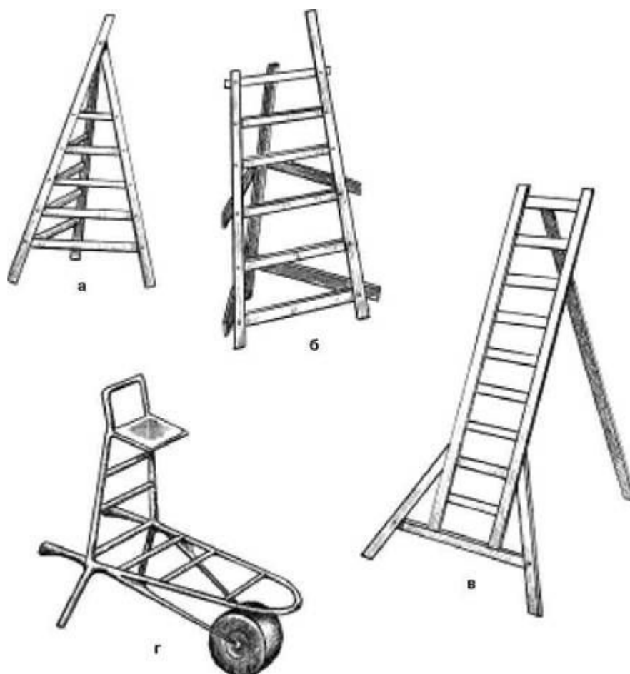
Инвентарь для уборки плодов: а – простой треножник; б – треножник с помостом; в – лестница с упорами; г – комбинированная лестница-тачка
