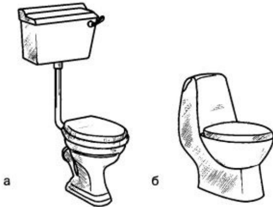
Рис. 3. Конструкции унитазов: а — раздельный: б — моноблок
