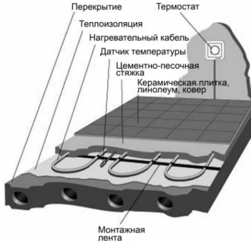
Рис. 7. Схема устройства теплых полов
