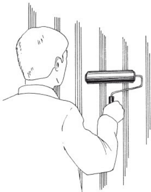
Рис. 75. Разглаживание обоев с помощью валика
