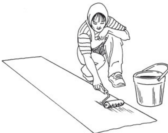
Рис. 74. Нанесение клея на обои с помощью валика
