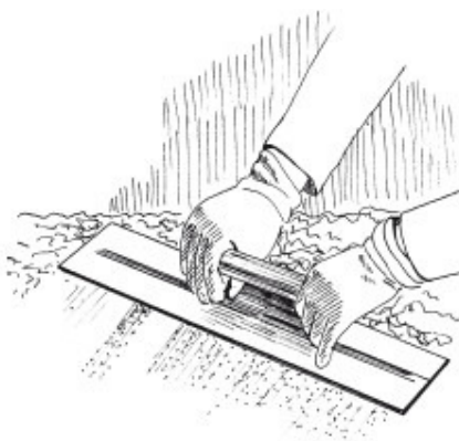
Рис. 57. Выравнивание раствора при выполнении стяжки
