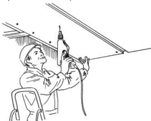
Рис. 48. Крепление гипсокартонных плит к обрешетке
