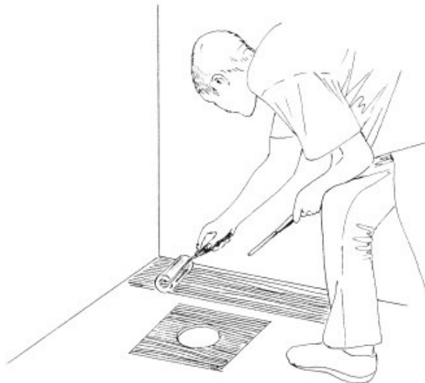
Рис. 60. Нанесение гидроизоляционного состава на пол в ванной
