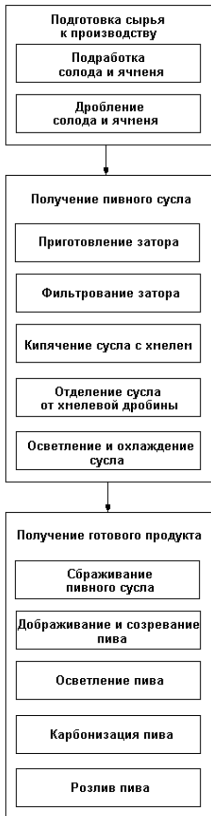
Рис. 2.1. Функциональная схема производства пива
