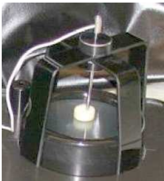
Рис. 8-6-7. Устройство для фиксации кусочков фруктов при регистрации свечения.
