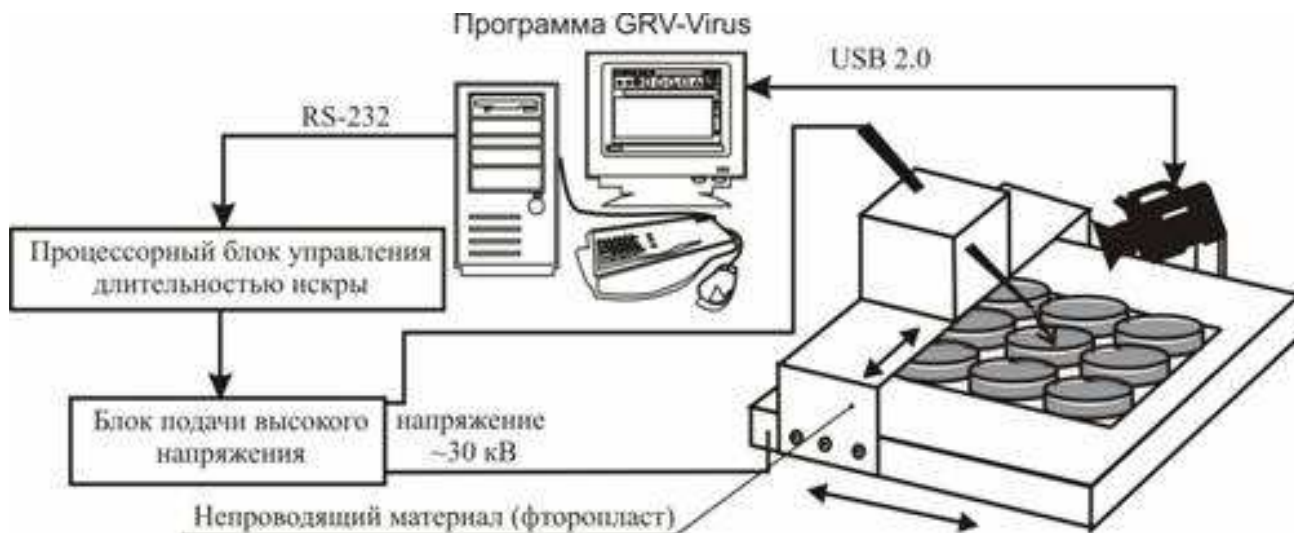
Рис. 8-5-1. Структурная схема системы исследования вирусных инфекций методом ГРВ.
