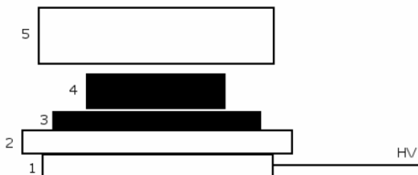
Рис. 5-7-39. Схема установки. 1-металлический электрод, 2-изолятоор, 3-фотопленка, 4-объект, 5-электрод.
