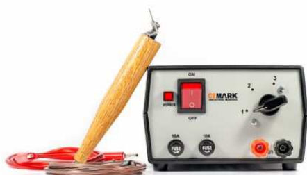
Рис. 13-2-4. Электрокарандаш модель VCM-150N фирмы CEMark (Чехия). Сменный вольфрамовый электрод диаметром 1,0 и 1,2 мм. Четырехступенчатая регулировка мощности искры.
