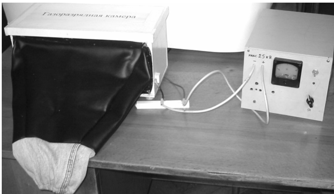
Рис. 13-6-4. Установка для газоразрядного фотографирования.
