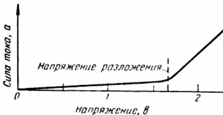
Рис. 10-7-19. Зависимость силы тока от приложенного напряжения при электролизе.
