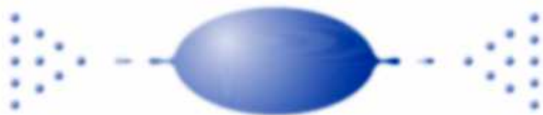
Рис. 10-6-19. Схематическое изображение неустойчивой по отношению к собственному заряду капли, сбрасывающей избыточный заряд путем эмиссии высокодисперсных сильно заряженных капелек.
