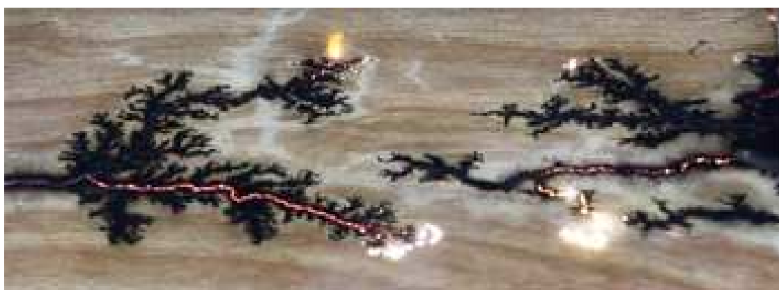
Рис. 10-7-2. Распространение разряда по поверхности деревянной доски, смоченной раствором соды. Два снимка сделаны с интервалом в 10 секунд.
