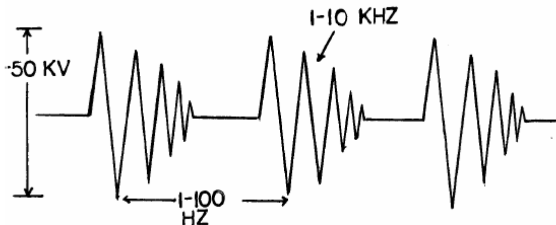
Рис. 10-1-1. Осциллограмма сигнала с генератора в установке Кирлиана С.Д.
