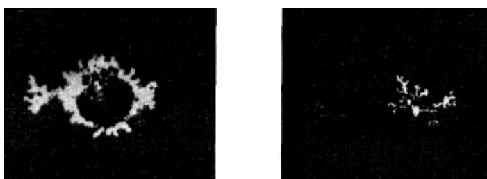
Рис. 10-7-5. Положительный и отрицательный разряд в жидкости, напряжение 35кВ. Изображение увеличено в 1,5 раз.
