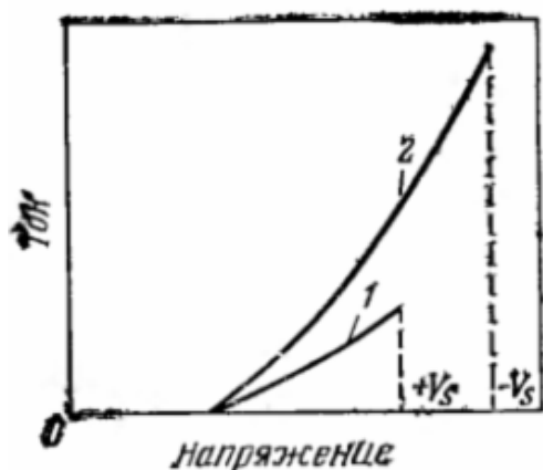
Рис. 10-1-37. Зависимость тока от напряжения при коронном разряде, 1-положительный, 2-отрицательный.
