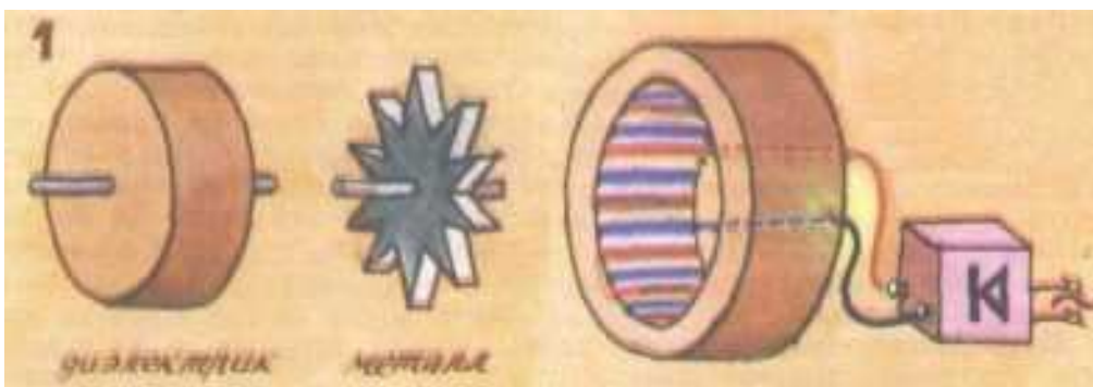
Рис. 10-7-43. Устройство нового двигателя: статор, выпрямитель и роторы-диэлектрический и металлический. Статор-это пластиковый цилиндр с электродами (проводами) внутри, на которые поочередно поданы высокие потенциалы разного знака (красный и синий цвета).
