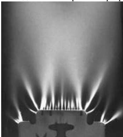
Рис. 10-6-15. Фотография коронного разряда с бритвенного лезвия при подаче на него положительного электрического потенциала 10кВ. Фотография получена с выдержкой 10с.
