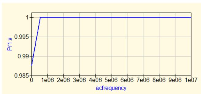
Ранее уже упоминалось, что более привычный вид этой кривой может быть получен, если в диалоге свойств диаграммы выбрать логарифмическое отображение по оси X.
