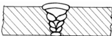
Рис. 110. Многопроходное сечение стыкового шва.
