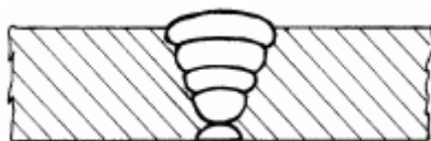
Рис. 109. Многослойное сечение стыкового шва.
