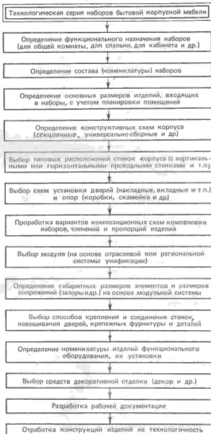
Рис. 129. Примерная последовательность разработки технологических серий наборов корпусной мебели
