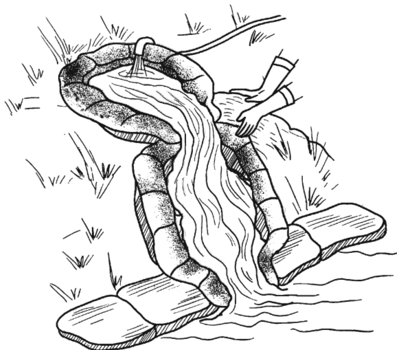
Рис. 74. Заполнение пространства между формой и грунтом
