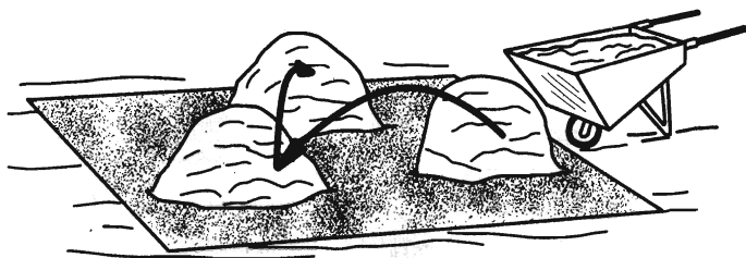
Рис. 16. Приготовление бетона способом гарцевания
