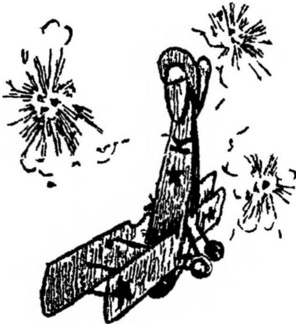
Рис. 35. Штопор. На рисунке показаны разрывы снарядов, от которых нередко приходится уходить быстрым снижением, напр. путем штопора.
