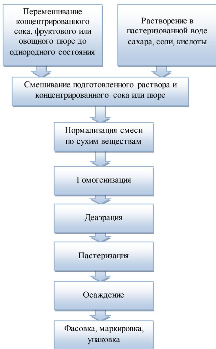
Рис. 2.3. Функциональная схема производства нектаров и восстановленных соков
