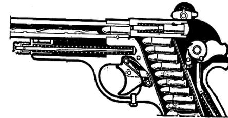
Рис. 9. Затвор в переднем положении.
