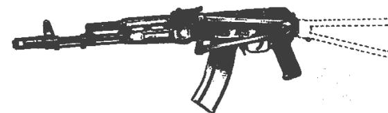
Рис. 16. 5,45-мм автомат Калашникова со складывающимся прикладом (АКС74).
