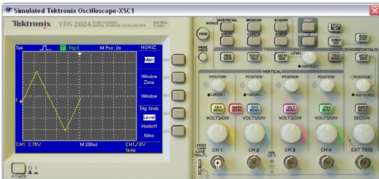
Рис. 3.5. Вид переменного треугольного напряжения на экране осциллографа
