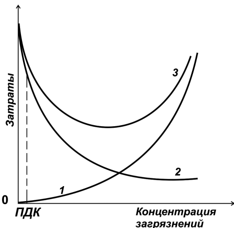
Рис. 3.4. Зависимость величины затрат на очистку сточных вод от концентрации содержащихся в них загрязняющих веществ (объяснения в тексте).
