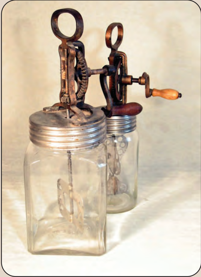
2429. Маслобйна стек- лянная кругл., наилуч- шей усовершенств. си- стемы, сбиваетъ масло въ 15 минутъ.
