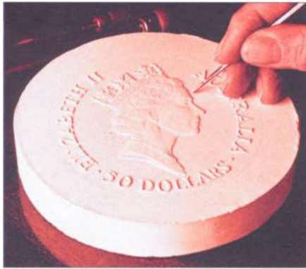
Сверху: Увеличенная гипсовая модель монеты доводится до совершенства и только после этого создается маточник нужного размера
