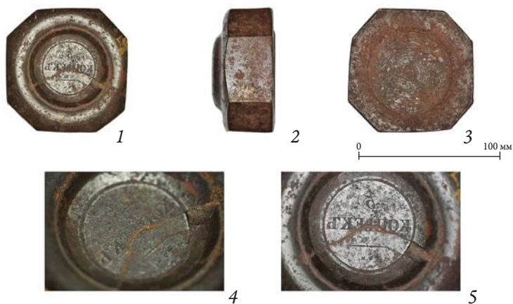
5. Штемпель о. с. монеты номиналом 5 копеек образца 1830 г.: 1 — вид сверху; 2 — вид сбоку; 3 — вид снизу; 4, 5 — детали рельефа, трещины и сколы рабочей поверхности
