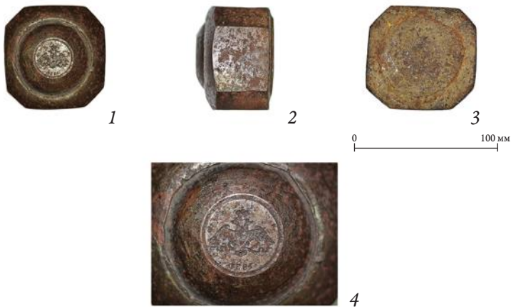
4. Штемпель л. с. монеты номиналом 1 копейка 1830 г.: 1 — вид сверху; 2 — вид сбоку; 3 — вид снизу; 4 — детали рельефа и рабочей поверхности
