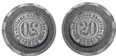
Рис. 5. Штемпель в форме «усеченного конуса» о. с. 20 копеек с датой «1911» (вариант 1) с надписью «РОССИЙСКАЯ ИМПЕРИЯ» и его зеркальное отображение. Сталь. Минцкабинет СПМД. Уменьшено
