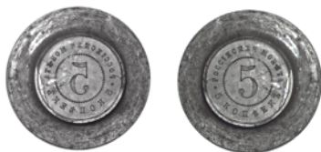
Рис. 11. Штемпель «цилиндрической» формы о. с. 5 копеек с датой «1911» с трещинами и его зеркальное отображение. Сталь. Минцкабинет СПМД. Уменьшено
