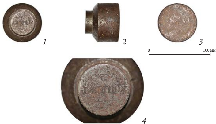
б. Штемпель о. с. монеты номиналом 5 копеек образца 1830 г.: 1 — вид сверху; 2 — вид сбоку; 3 — вид снизу; 4 — детали рельефа и рабочей поверхности
