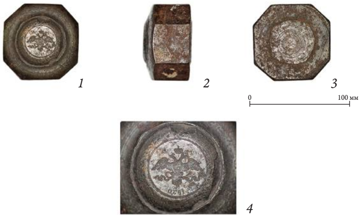
3. Штемпель л. с. монеты номиналом 2 копейки 1830 г.: 1 — вид сверху; 2 — вид сбоку; 3 — вид снизу; 4 — детали рельефа и сколы рабочей поверхности
