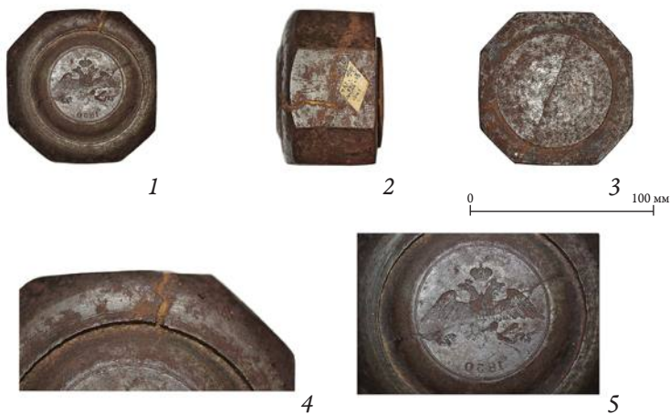
2. Штемпель л. с. монеты номиналом 5 копеек 1830 г.: 1 — вид сверху; 2 — вид сбоку; 3 — вид снизу; 4 — трещина обоймы; 5 — детали рельефа
