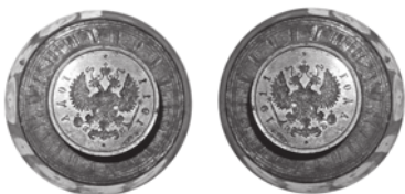
Рис. 10. Штемпель в форме «усеченного конуса» л. с. 5 копеек с датой «1911» с шестиконечными звездами и его зеркальное отображение. Сталь. Минцкабинет СПМД. Уменьшено
