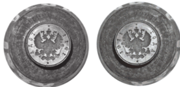
Рис. 13. Штемпель в форме «усеченного конуса» л. с. 3 копеек, вероятно, для 5 копеек с датой «1911», с надписью «1911» и «ГОДА» и шестиконечными звездами и его зеркальное отображение. Сталь. Минцкабинет СПМД. Уменьшено
