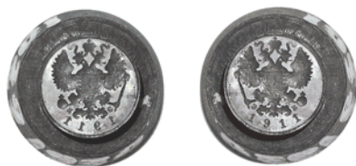
Рис. 7. Штемпель в форме «усеченного конуса» л. с. 10 копеек с датой «1911» с надписью «1911» и его зеркальное отображение. Сталь. Минцкабинет СПМД. Уменьшено
