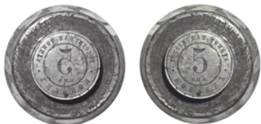
Рис. 12. Штемпель в форме «усеченного конуса» о. с. 5 копеек с датой «1911» и буквами «С. П. Б.» и его зеркальное отображение. Сталь. Минцкабинет СПМД. Уменьшено
