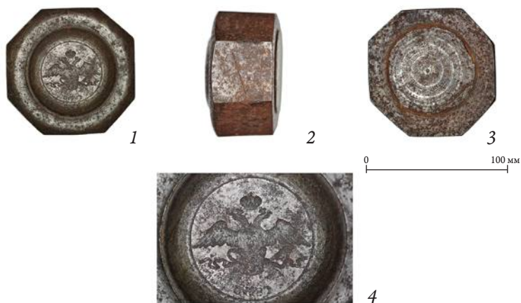
1. Штемпель л. с. монеты номиналом 10 копеек 1830 г.: 1 — вид сверху; 2 — вид сбоку; 3 — вид снизу; 4 — детали рельефа
