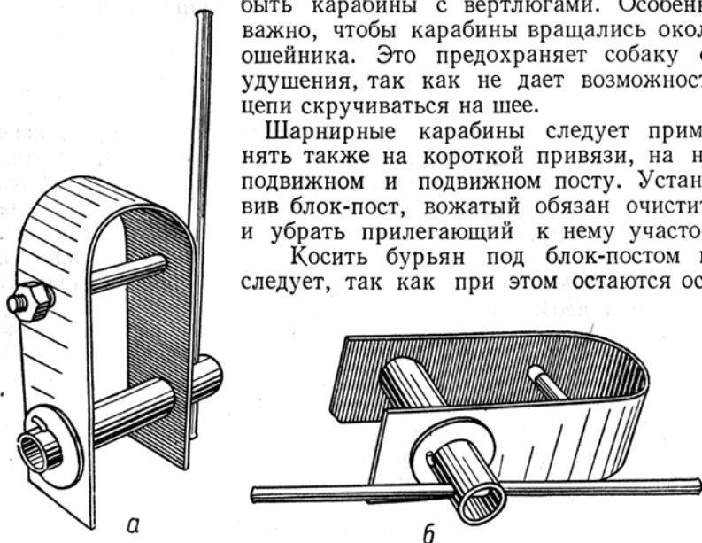
Рис. 51. Спецоборудование для натяжки проволоки на блок-пост (второй вариант): а — вид сбоку; б — вид сверху.
