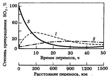
Р и с. 10. Образование серной кислоты (1) и сульфата аммония (2) при превращении оксида серы (3) в природных условиях
