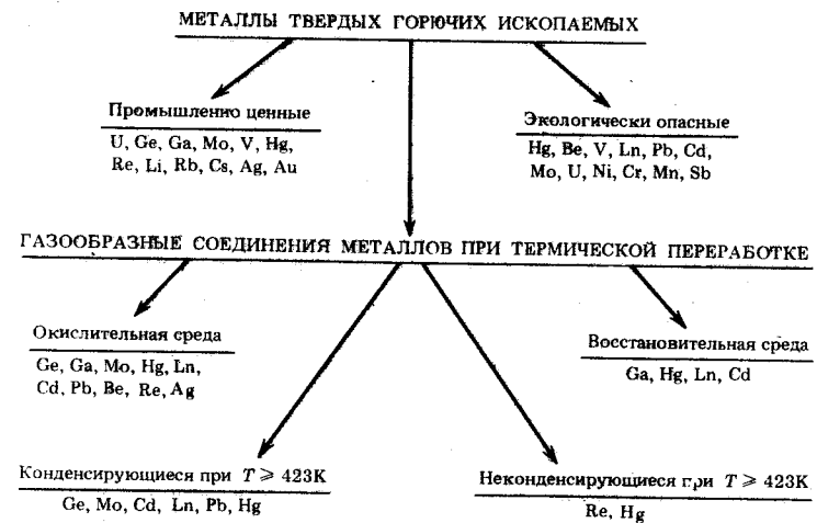
Р и с. 18. Металлы твердых горючих ископаемых и их поведение в процессе горения
