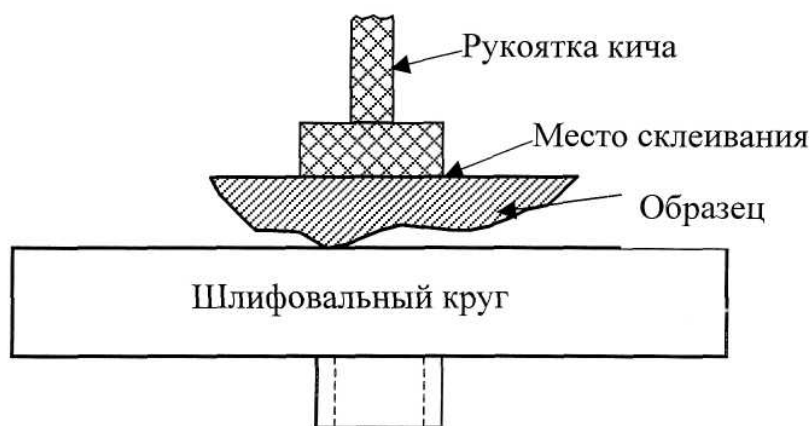
Рис. 44. Схема шлифовки камня закрепленного к кичу
