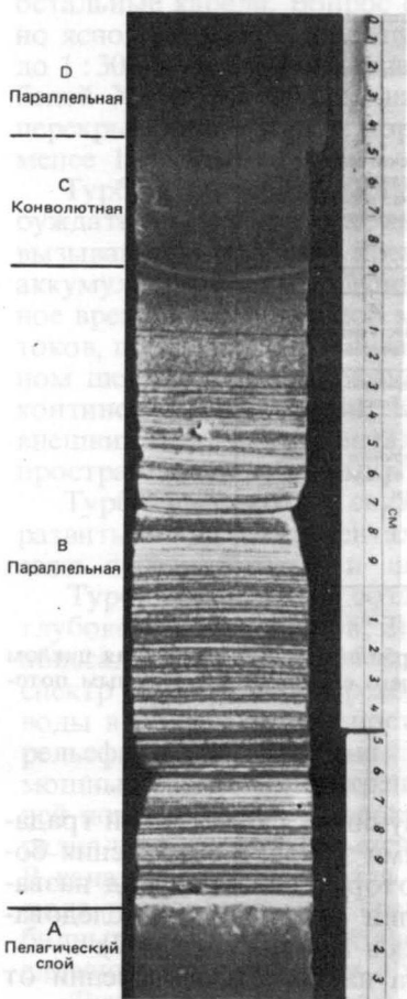
Рис. 13-8. Фотография керна бурения с турбидами из юго-восточной части Тихого океана. Выделены интервалы полного цикла Боума [1048].
