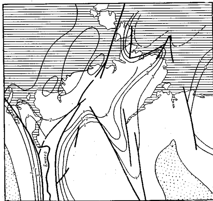
Рис. 89. Рифейский прогиб на территории Таймыра и прилегающих районов (по Ю. Е. Погребницкому, К. К. Демюкидову, Я. И. Полькину). Точки — области поднятия. Белое поле с изоляциями — область прогибания в изоплахтах, км. Черные линии — разломы
