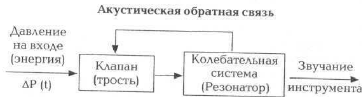
Рис. 2. Структурная схема автоколебательной системы духовых инструментов
