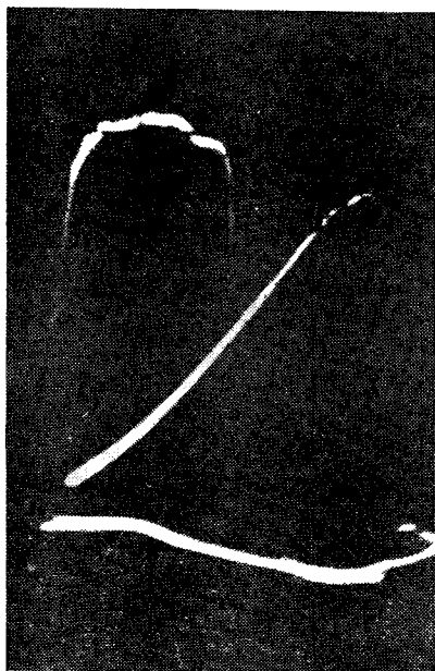
Рис. 155. Осциллограммы импульсов э. д. с., получаемых с индукционного датчика при ударах приемом стаккато и легато (а) и зависимость их формы от силы удара по клавише (б)
