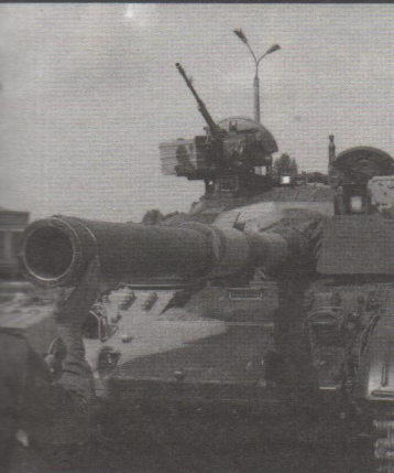
Основным вооружением танка БМ "Булат" является 125-мм гладкоствольная танковая пушка - пусковая установка КБА3 или 2А46М-1
