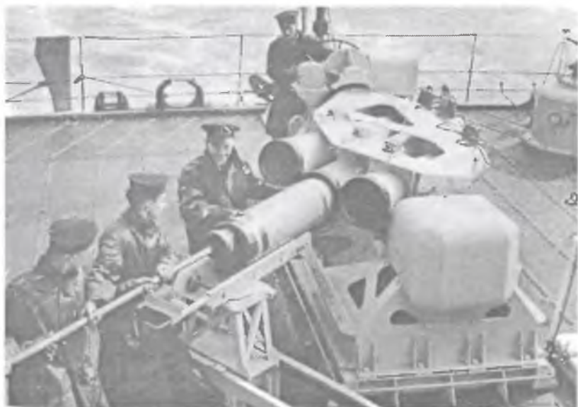
«Squid», трехствольный бомбомет — грозное оружие против подводных лодок
