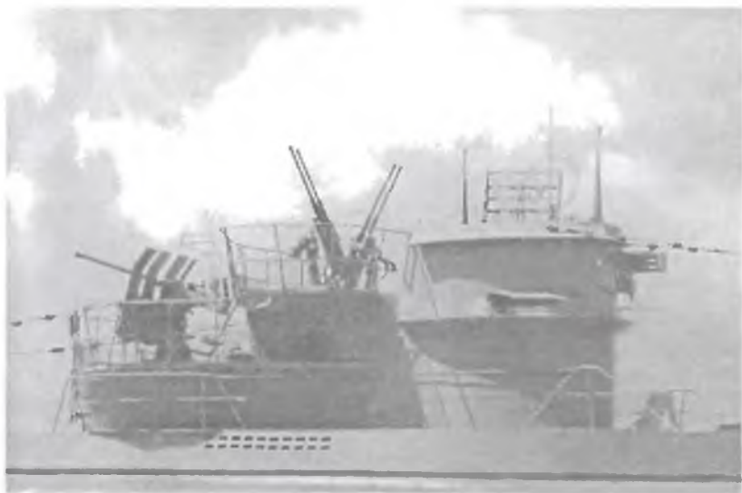
Усиленное зенитное вооружение германской субмарины: одно 37-мм орудие и две спаренные установки 20-мм автоматов
