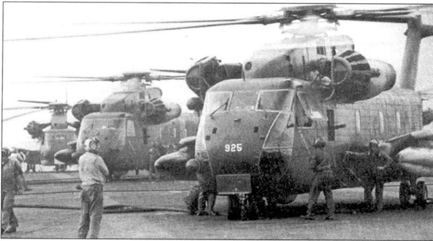
Вертолеты Sikorsky CH-53C «Knife» из 21 SOS на палубе авианосца USS «Midway» в ходе операции «Frequent Wind». В окне за кабиной пилотов виден ствол одного из трех «миниганов», составлявших штатное вооружение вертолета.
