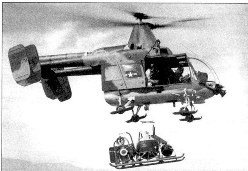
Хотя на оснащение спасательных частей поступили большие вертолеты HH-3E и HH-53C, маленькие «Каган» HH-43F «Pedro» продолжали использоваться в небольших операциях в непосредственной близости от базы. На фото «Pedro» транспортирует стационарный огнетушитель.
