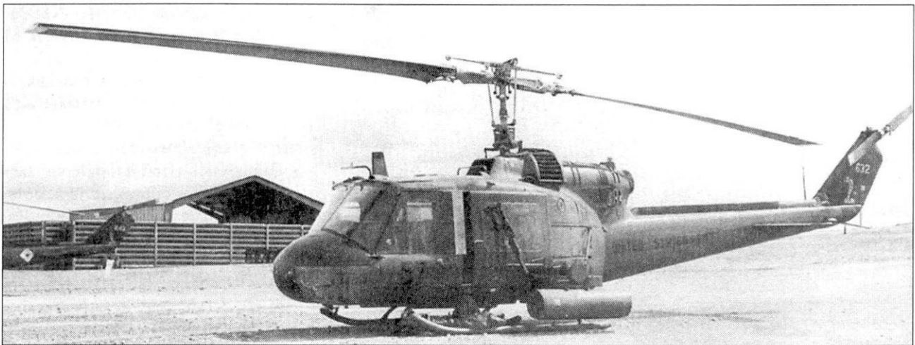
Ракетный UH-1C из 57 АНС, база Пхукат, 1971 год. Вертолет вооружен пусковой установкой XM-159 и двумя пулеметами M-60 на станках «Sagami». На хвосте виден силуэт кобры - в прошлом вертолет принадлежал 129 АНС.
