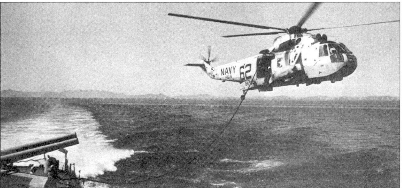
Sikorsky SH-3A «Sea King» из HS-8 запрашивается с помощью системы HIFR от эсминца USS «Steinake» (DD-683), Тонкинский залив, сентябрь 1968 года.
