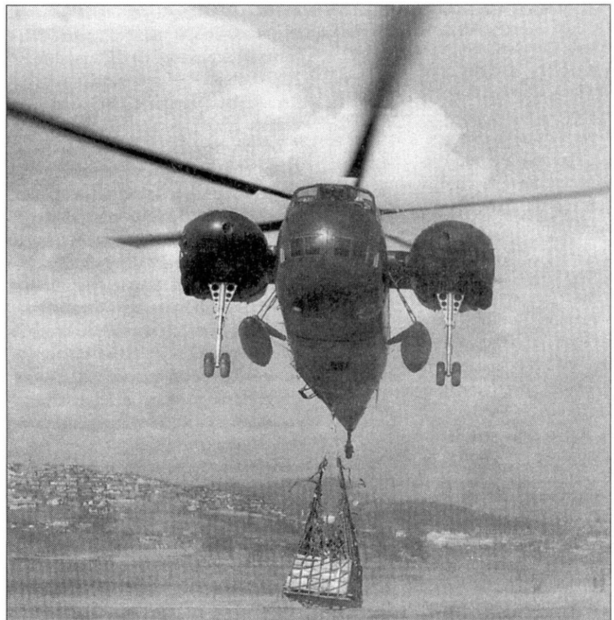
Sikorsky CH-37 был первым транспортным вертолетом корпуса морской пехоты, способным полноценно снабжать изолированные базы и блокпосты.
