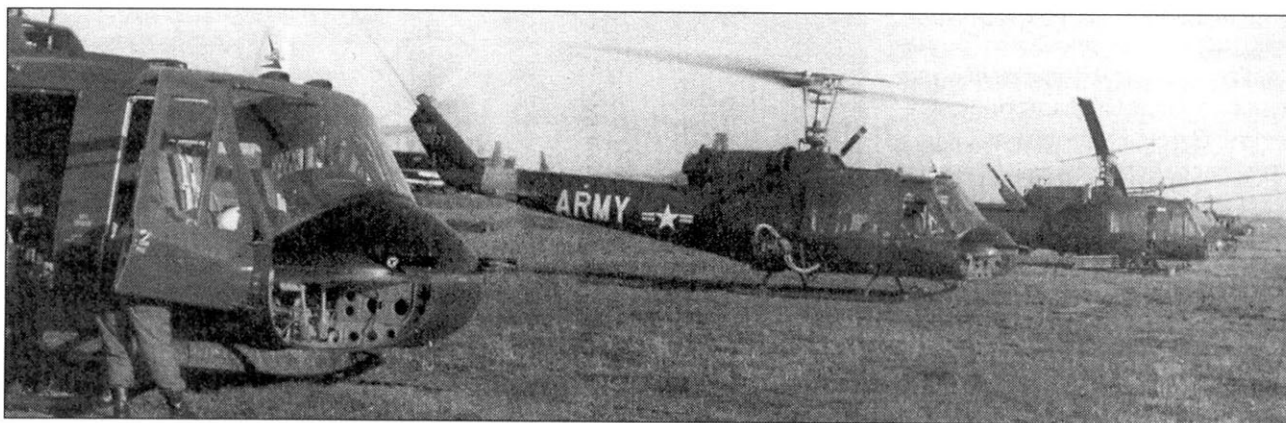
В ноябре 1962 года УТТНСО получила новенькие УН-1В. На фотографии новые машины оснащены системой ХМ-6. На заднем плане старый УН-1А.
