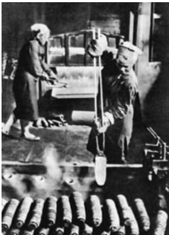
Производство корпусов артиллерийских снарядов
