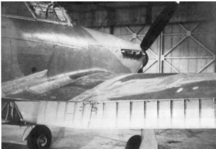
Проверка выпуска посадочных щитков
