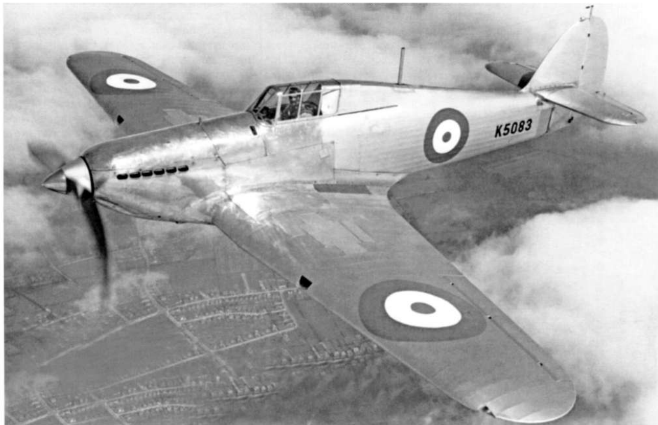
Опытный образец «Харрикейна» в полете. На самолете уже установлены прицел и новый фонарь кабины
