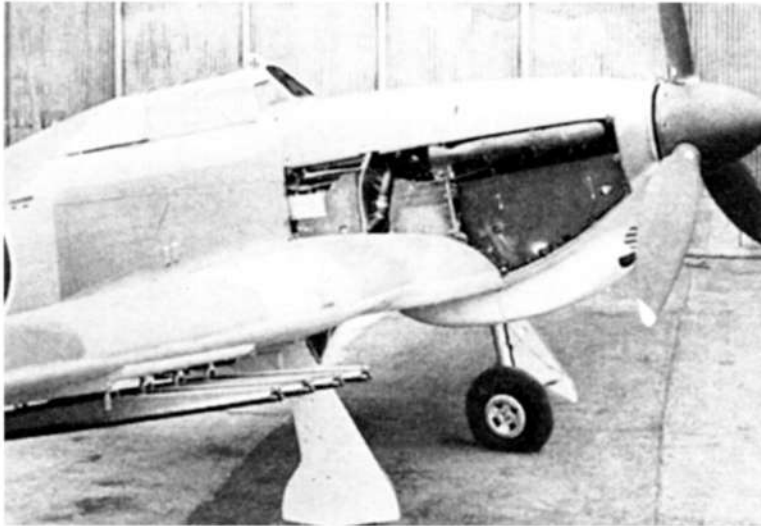
«Харрикейн» IV с пусковыми балками реактивных снарядов. Видны бронелисты, прикрывающие двигатель
