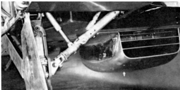
Радиатор опытного образца отличался от последующих серийных машин
