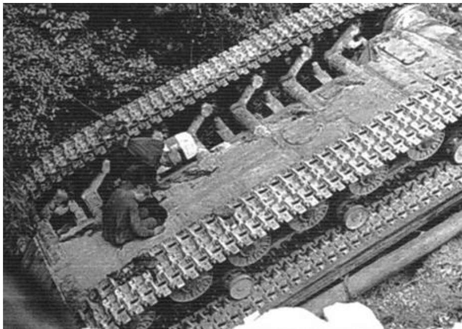
Перевернувшийся танк. Хорошо видны люки на днище корпуса
