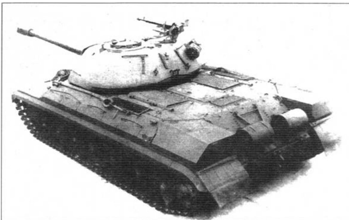
Серийный танк Т-10 первых выпусков, вооружённый 122-мм орудием Д-25ТА с двухкамерным дульным тормозом; на башне 12,7мм пулемёт ДШКМ. На корме установлены дополнительные топливные баки
