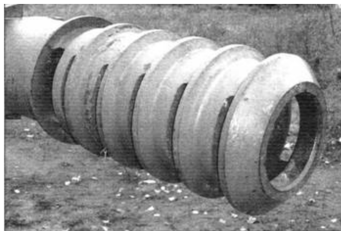
Щелевой дульный тормоз 122-мм орудия М-68Т2С танка Т-10М
