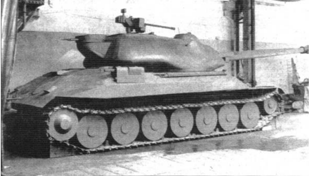
Деревянный макет первого варианта танка ИС-7 в натуральную величину, выполненный для проверки компоновочных решений
