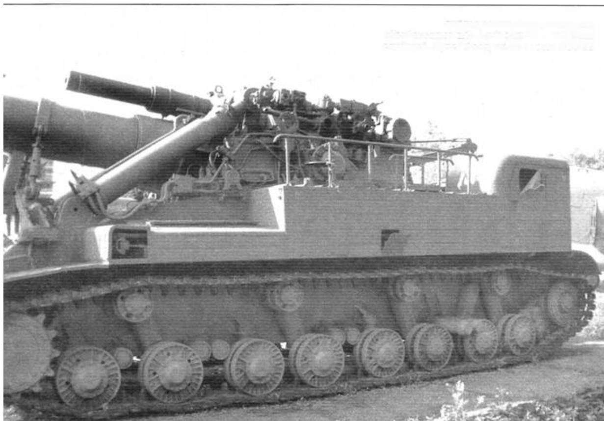
Тяжёлая самоходная установка «Конденсатор 2П» («объект 271») с 406-мм гаубицей. Музей Вооружённых Сил, Москва
