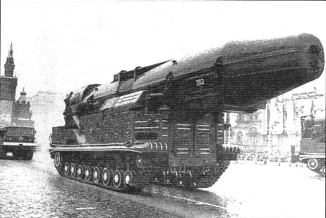
Внизу: Самоходная пусковая установка ракетного комплекса средней дальности 15П696 ракеты РТ-15 (8К-96, твердотопливная двухступенчатая)
