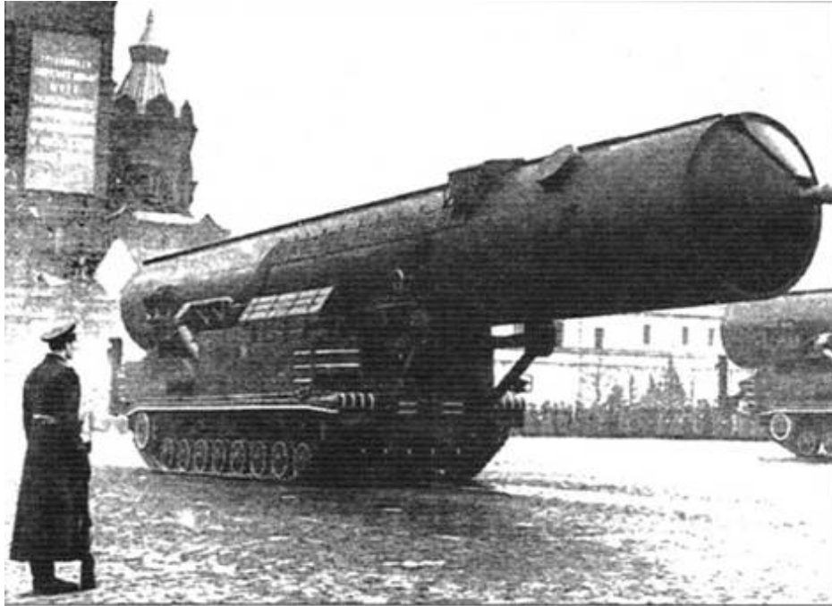
Вверху: Самоходная пусковая установка ракетного комплекса 15П699 ракеты РТ-20 (8К-99, межконтинентальная баллистическая)
