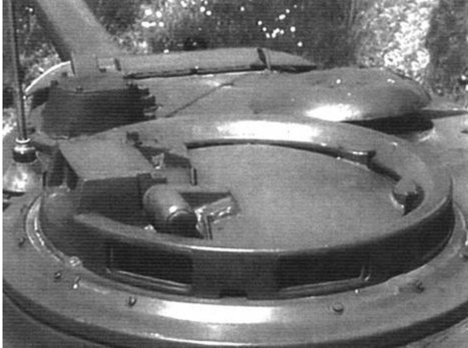
Командирская башенка танка Т-10А. Хорошо видны приборы наблюдения командира
