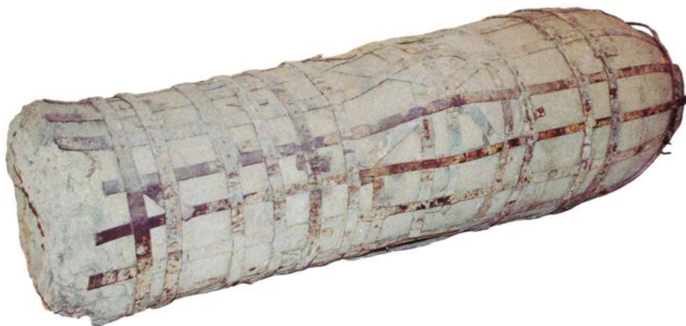
Готовая к отливке форма. Джайгарх. Фотография автора
