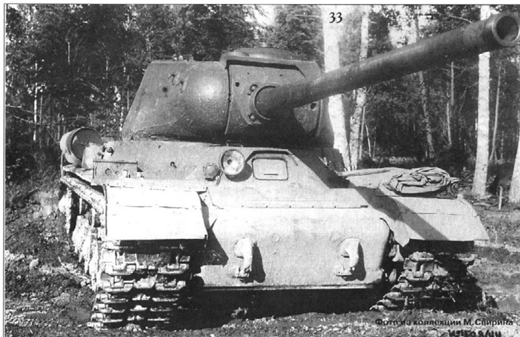
32-33 Танк ИС-4 (Объект 245), вооруженный орудием Д-10Т, после испытаний стрельбой. Лето 1944 г.
