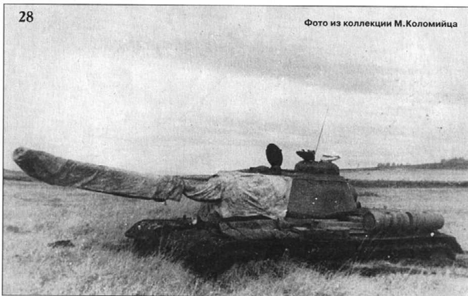
27-28 Опытный танк ИС-122 (Объект 240), вооруженный 122-мм орудием Д-25 (А-19 танковая) во время Государственных испытаний. Осень 1943 г. The experimental IS-122 (object 240) during State trials. Autumn 1943.
