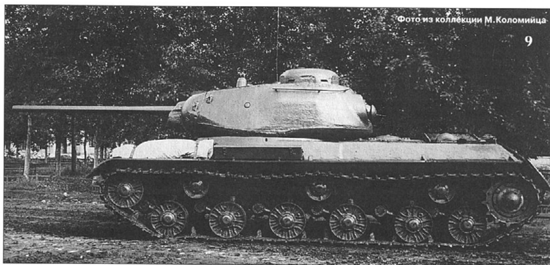
8-9 Опытный танк ИС «образец № 3» (Объект 237), вооруженный орудием С-18, после испытаний пробегом. Лето 1943 г. The experimental tank IS "Prototype #3" (Object 237) armed with the S-18 gun after drive test. Summer 1943.
