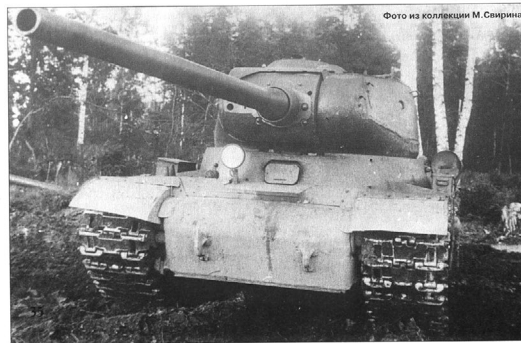
34-35 Тяжелый танк ИС-5 (Объект 248), вооруженный 100-мм пушкой С-34 ЦАКБ, после полигонных испытаний стрельбой. Лето 1944 г. The IS-5 heavy tank (Object 248) armed with 100-mm S-34 gun after test firing. Summer 1944
