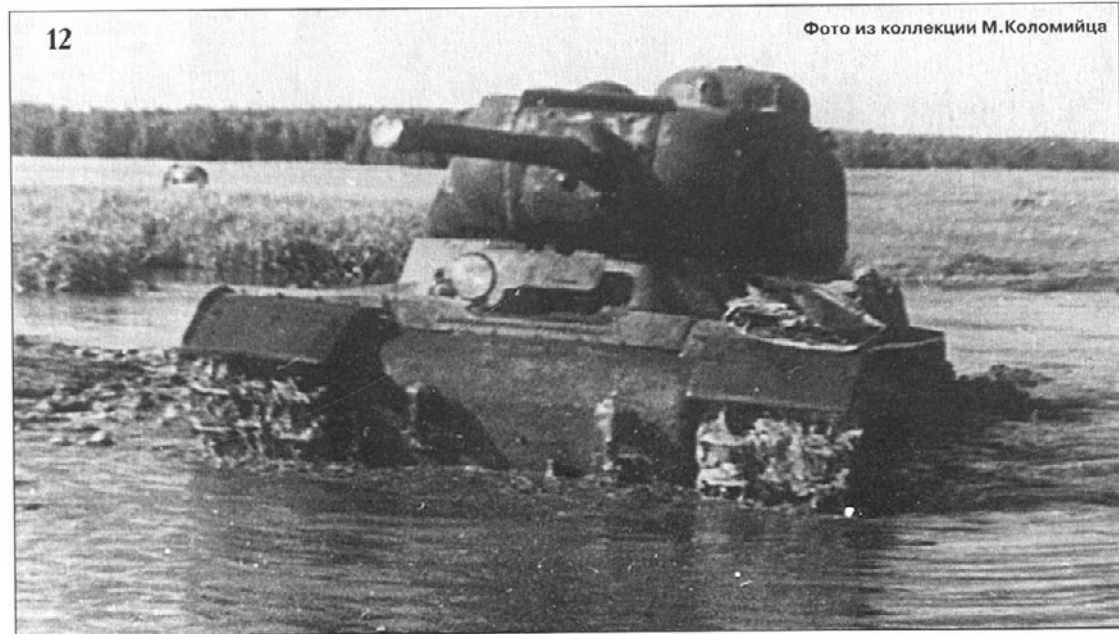
10-12 Опытный танк ИС, вооруженный 85-мм орудием С-31, во время Государственных испытаний. The experimental IS tank armed with 85-mm S-31 gun during State trials.
