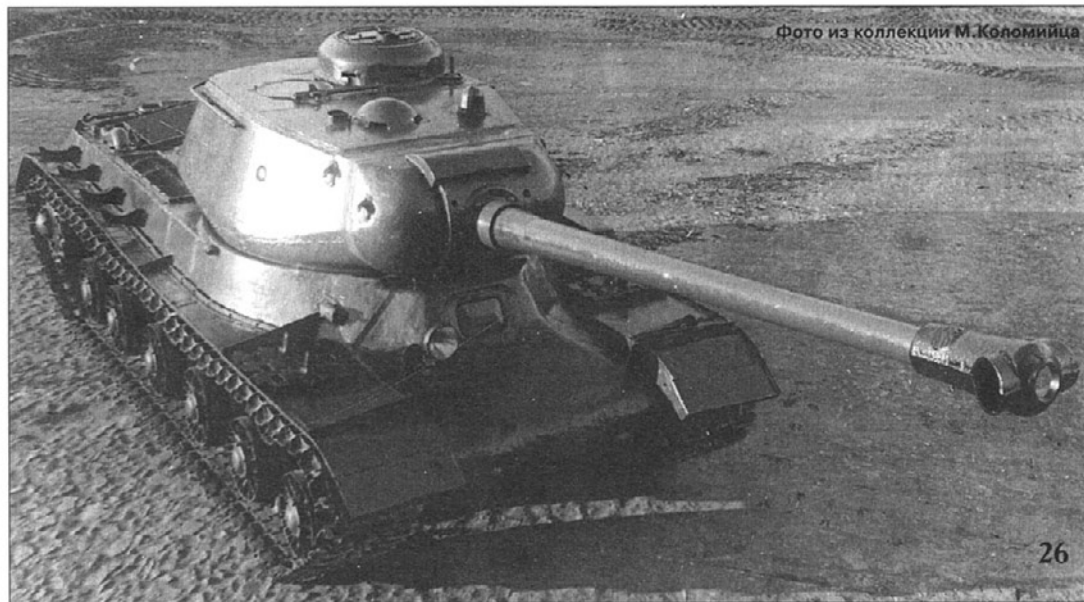
24-26 Опытный танк ИС-122 (Объект 240), вооруженный 122-мм орудием Д-25 (А-19 танковая) во дворе Челябинского Кировского завода. Осень 1943 г. The experimental IS-122 (Object 240) armed with the D-25 122-mm gun. Chellabinsk. 1943.
