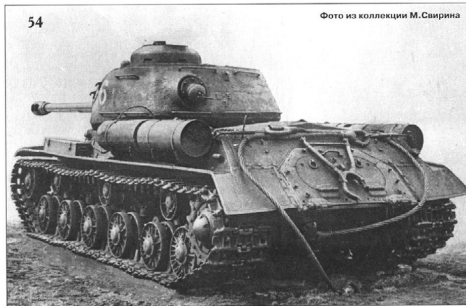
53-54 Тяжелый танк ИС со сварной носовой частью корпуса конструкции УЗТМ. 1945 г. The IS-2 heavy tank with welded bow designed at UTZM. 1945.
