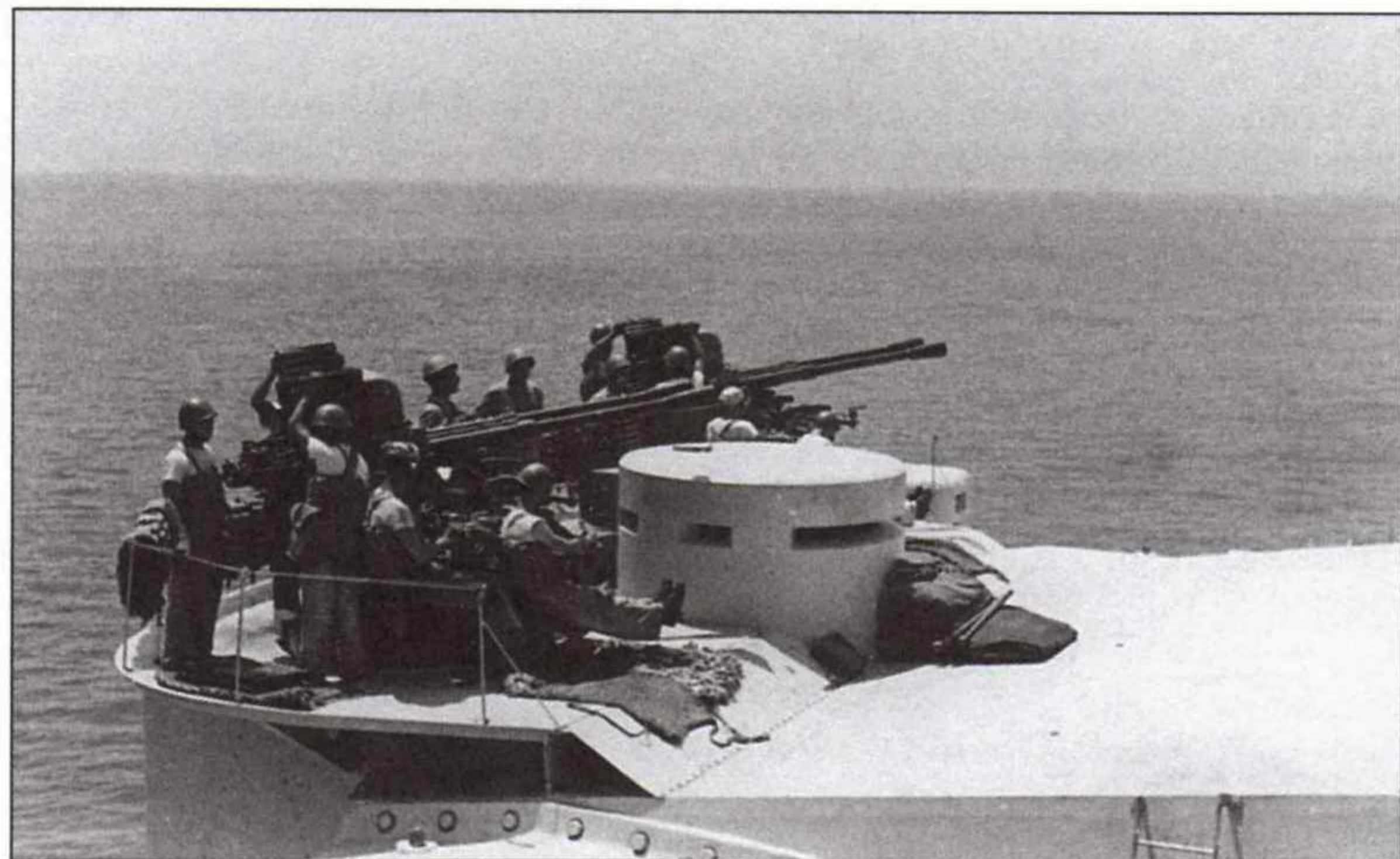
Спаренные 37-мм автоматы на крыше носовой возвышенной башни линкора «Литторио»
