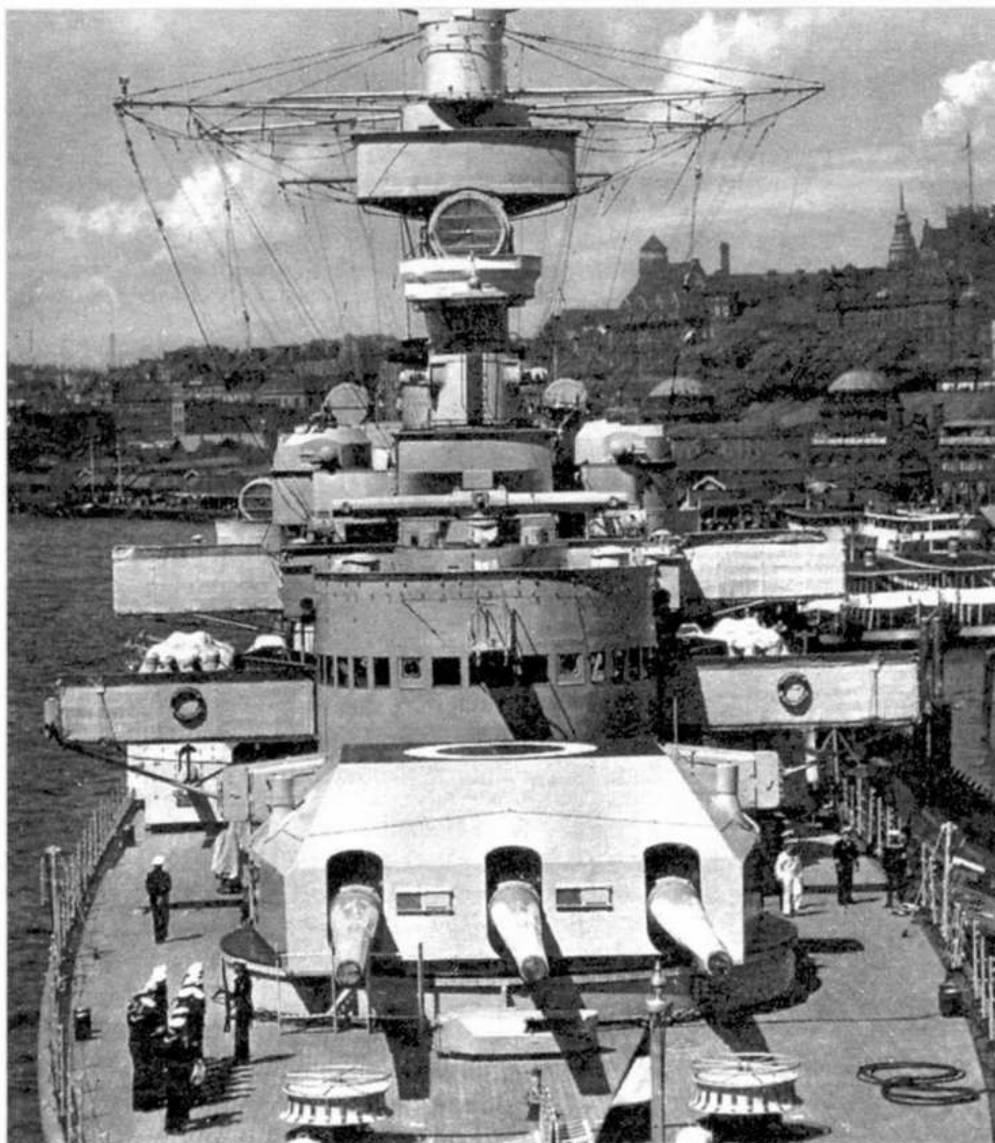
Башня ГК и надстройка «Deutschland»
