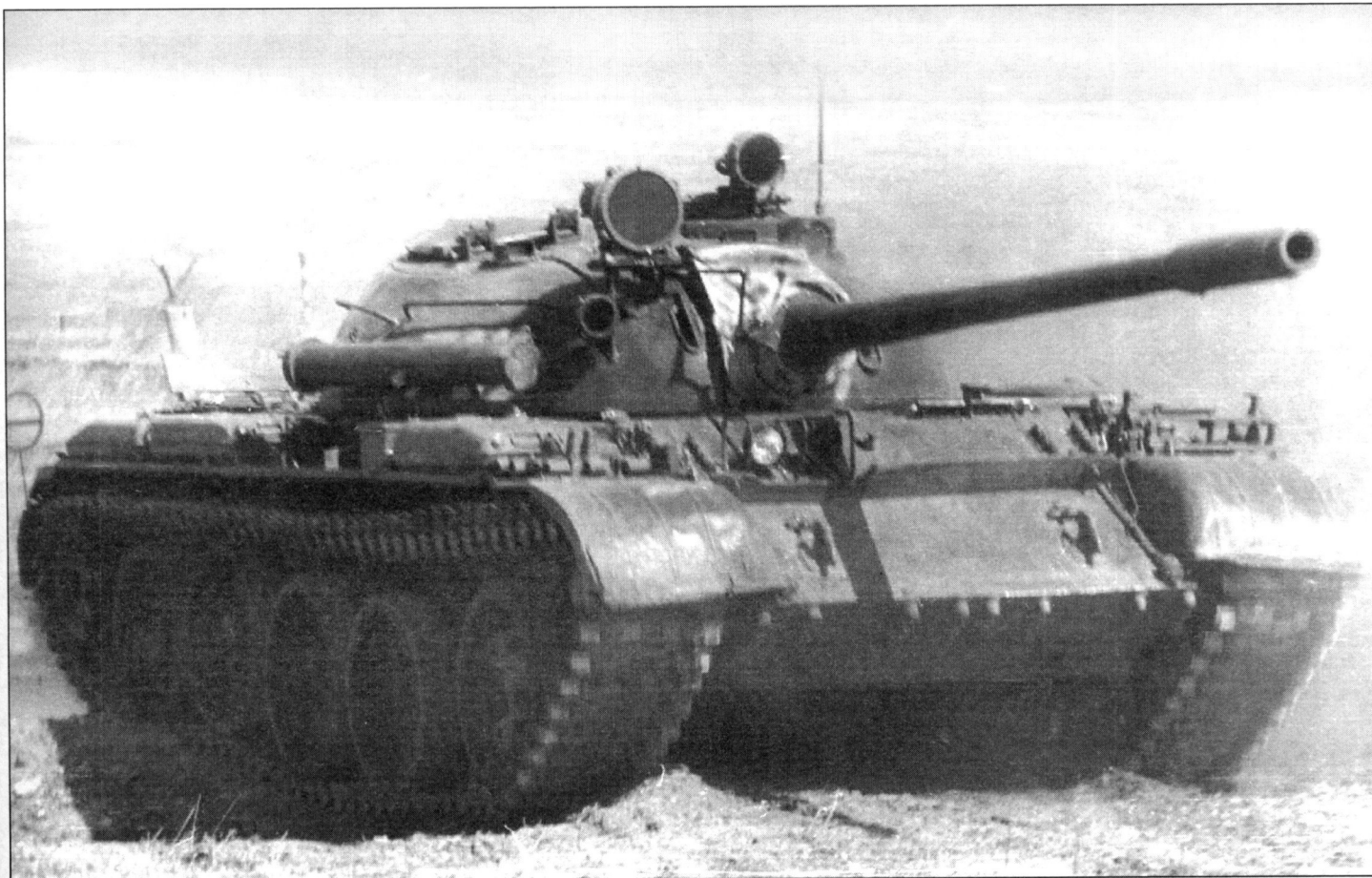
Гусеница танка с резинометаллическим шарниром РМШ Короткая труба ОПВТ на правой надгусеничной полке танка
