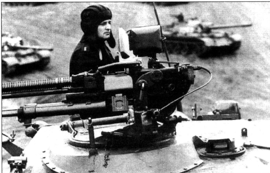
Зенитный пулемет ДШКМ в турели башни танка Т-55А (оснащение с 1969 года)
