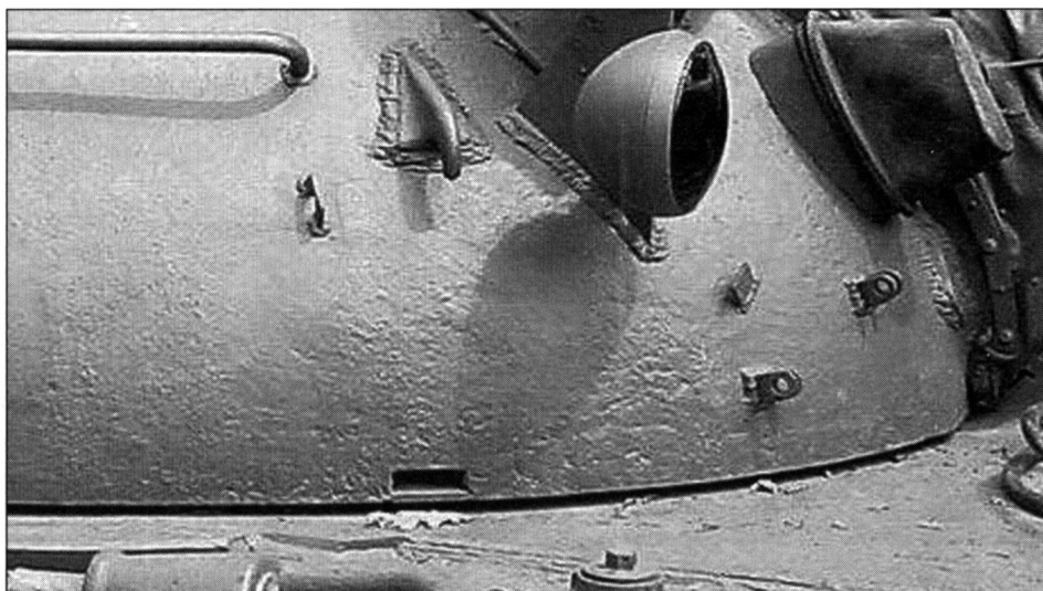
Нагнетатель-сепаратор — основной узел системы ПАЗ, создающий избыточное давление внутри танка
