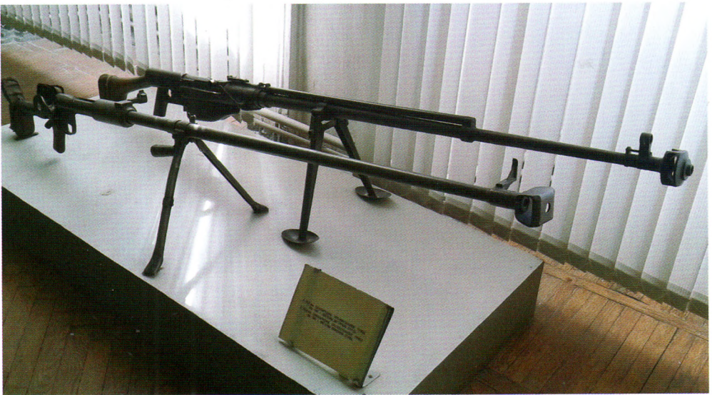
Пятизарядное 14,5 мм противотанковое ружье Симонова (ПТРС) и однозарядное 14,5 мм противотанковое ружье Дегтярева (ПТРД)
