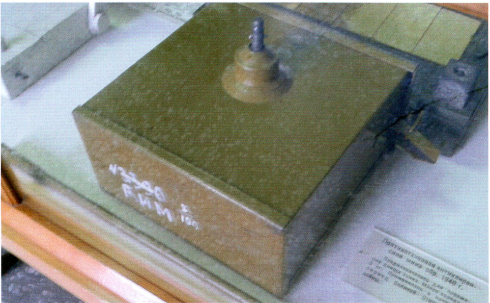
Противотанковая антиклиренсная (противоднищевая) мина
